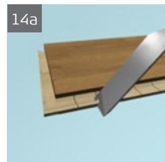
**14.** Если невозможно подвести доску под углом, например, под дверной коробкой или низким радиатором, действуйте следующим образом: **14a.** Вырежьте 2/3 фиксирующего элемента. **14b.** Нанесите клей. Поместите доску на место с помощью отжимки.
