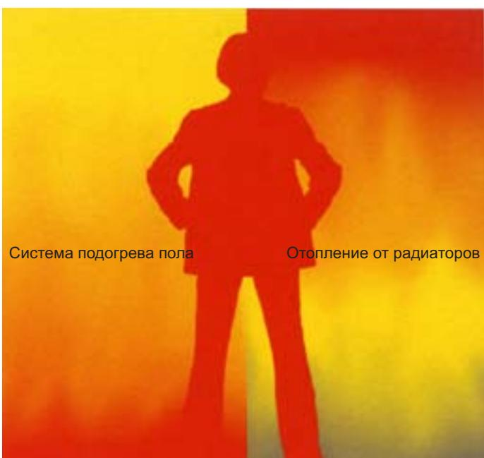
Система подогрева пола идеально распределяет тепло в пространстве.
